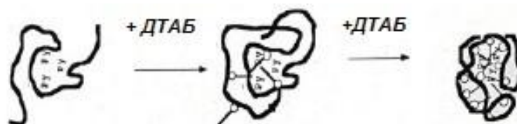
Рисунок 1.6 – Схематическое представление конформационных изменений меченой пиреном полиакриловой кислоты в процессе образования ПКК с додецилтриметиламмоний бромидом [43]
